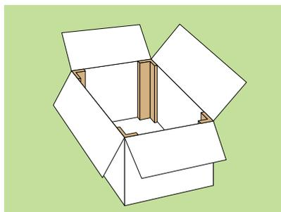
Упрочнение упаковки достигается соединением отдельных единиц упаковки с помощью углового картона.
