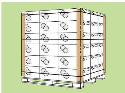
Угловой картон скрепляет поддоны между собой, что защищает изделия при транспортировке и складировании.
