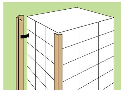
Использование самоклеящегося углового картона улучшает технологический процесс перед заключительной фазой-прикреплением строп.
